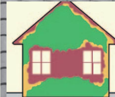
Ebenso verlässlich ist eine fachmännisch durchgeführte Thermografie. Hierbei wird mittels Wärmebildkamera die Oberflächentemperatur am Gebäude bildlich dargestellt. So werden Wärmebrücken und Luftundichtheiten sichtbar.
