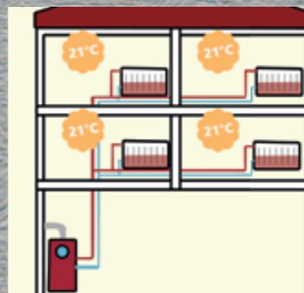
Dank des hydraulischen Abgleichs kann sich die Wärme gleichmäßig im ganzen Haus verteilen und störende Fließgeräusche gehören der Vergangenheit an. Zudem sinken die jährlichen Heizkosten durch einen geringeren Energieverbrauch.
